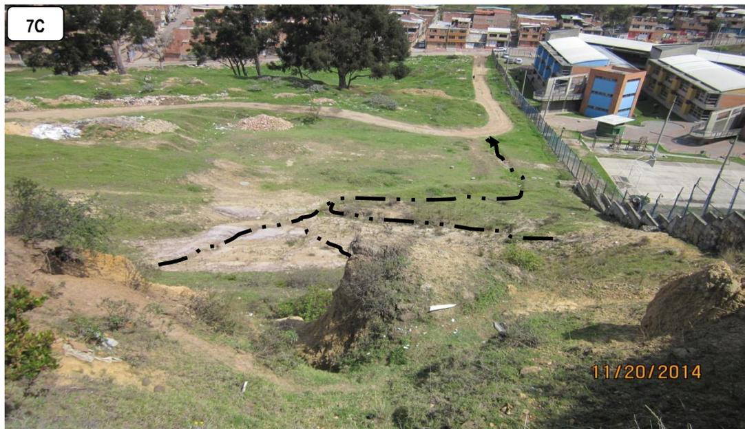
**Fotografías No. 7A, 7B y 7C. Antiguo Chircal María de Munevar.** Se aprecia en el antiguo patio los canales construidos en tierra y cubiertos de pasto kikuyo *Pennisetum clandestinum.*, por donde circulan las aguas de escorrentías.
