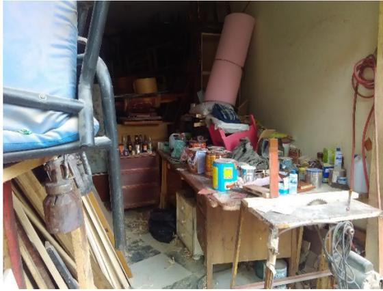
**5.2.2 COV's:** *El proceso de pintura de muebles en madera se realiza en la entrada del establecimiento, sin ductos ni dispositivos de control lo cual no garantiza una adecuada dispersión de las emisiones molestas, liberando al exterior gases COV's, compuestos orgánicos volátiles.*
