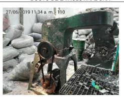
FOTOGRAFÍA No 5 PELETIZADORA EN PROCESO DE INSTALACIÓN
