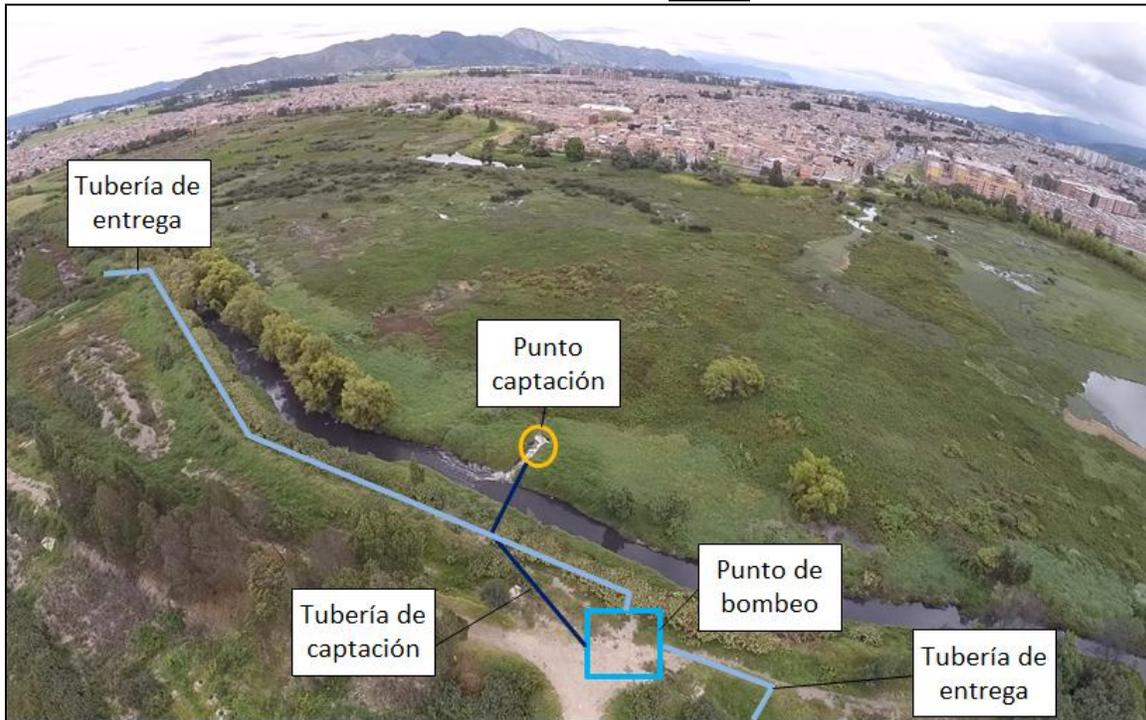
**Fotografía No. 9.** Ubicación aproximada del sistema hídrico de captación y entrega a los cuerpos de agua.
