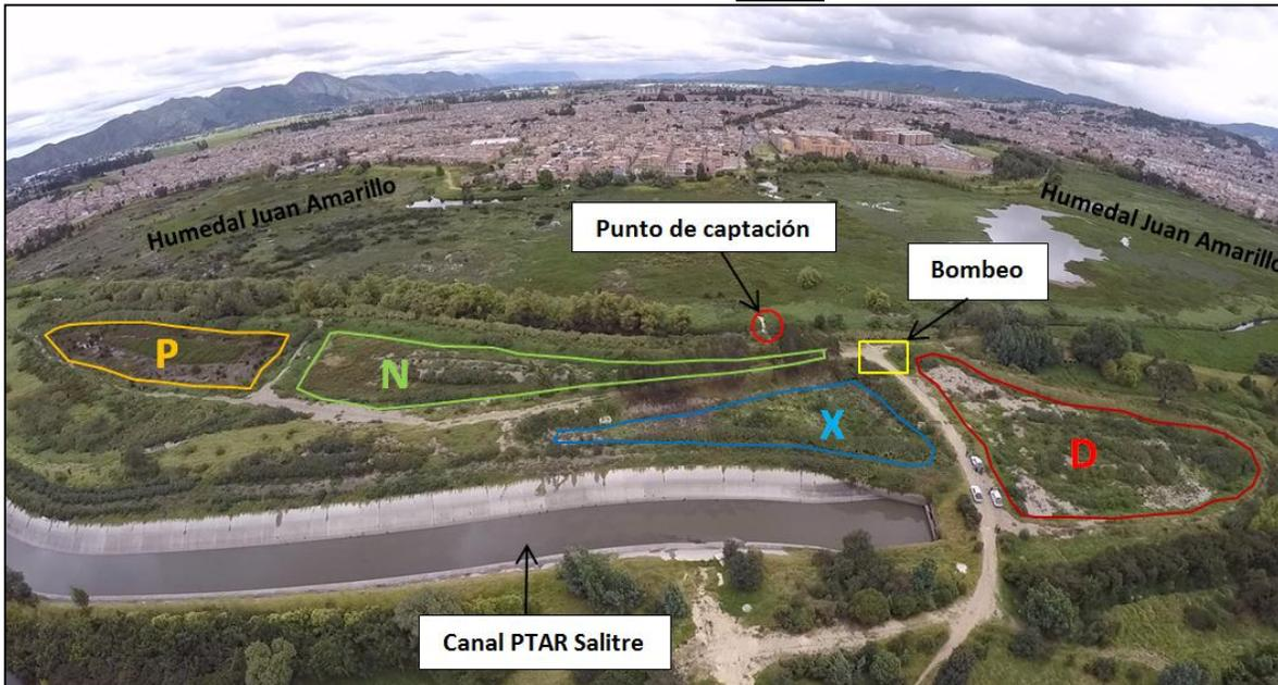
**Fotografía No. 1.** Vista general de la zona de intervención y ubicación de los cuerpos de agua, la estación de bombeo y el punto de captación hídrica, con respecto al humedal Juan Amarillo.
