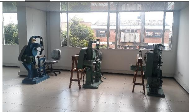
**Foto 14.** Tercer piso, detalle de máquinas abrillantadoras que se van a emplear en la etapa de terminación de pieles.
