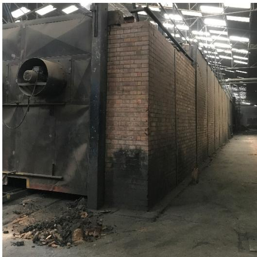
**Fotografía 7.** Horno tipo Túnel
