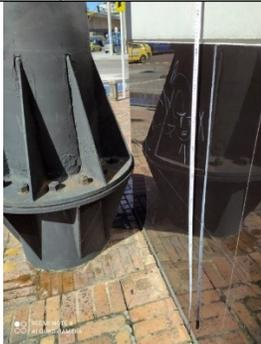
**Foto 7.** Colocación de cinta métrica a nivel del suelo respecto del punto de anclaje de la valla.
