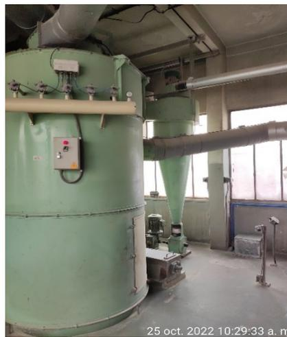
**Fotografía 10. Filtro de mangas del vibraklon**
