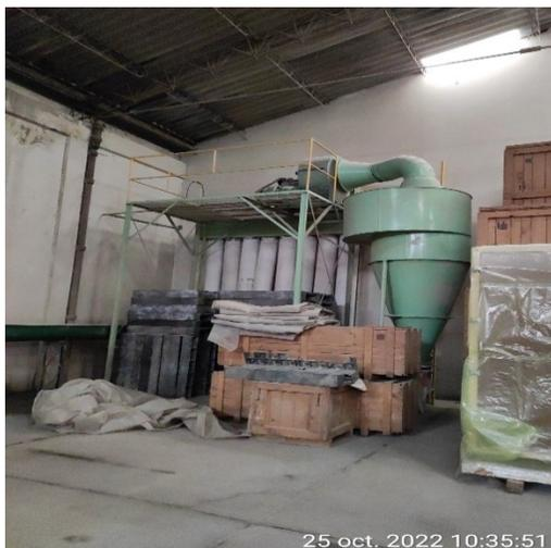
**Fotografía 5. Filtro de mangas ciclónico del área de descargue de materias primas**
