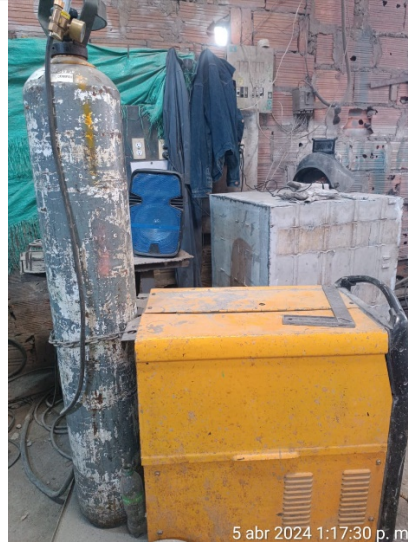
Fotografía No. 8: Cilindro de argón para actividades de soldadura.
