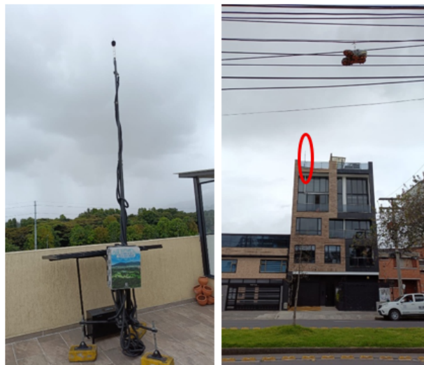
Fotografía 8 y 9 Mediciones al exterior mediante estación fija de monitoreo continuo de ruido ambiental
