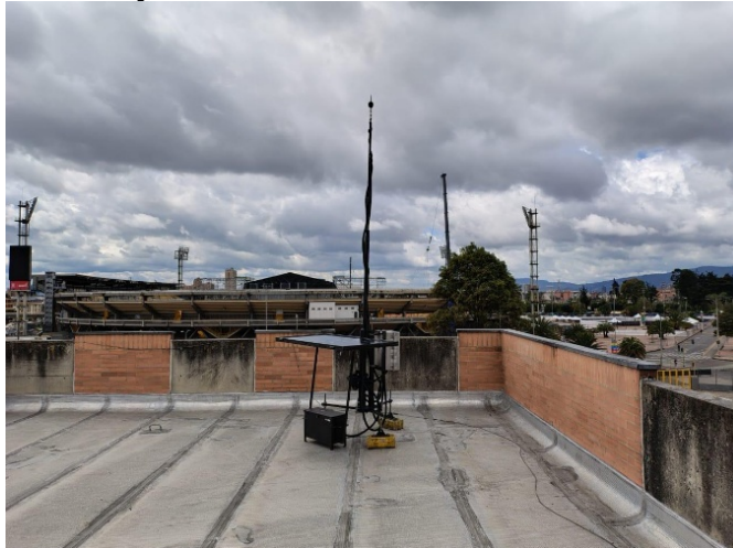
Fotografía 3. Estación fija de monitoreo continuo instalada en el Edificio Galerías PH
